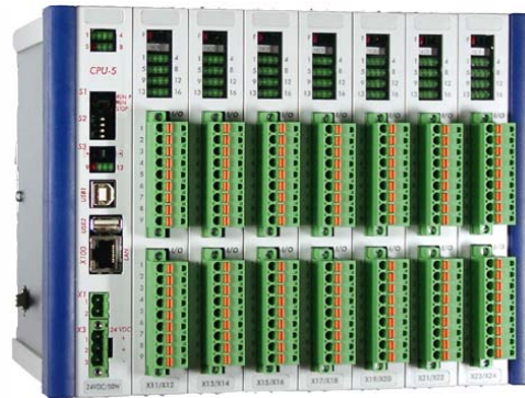
net-line FW-50 avec 7 cartes d'extension
